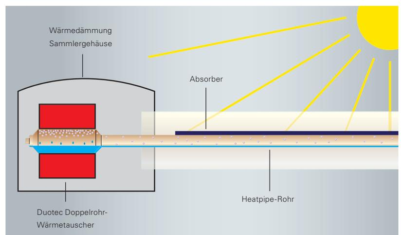
Das von der Sonne erhitzte Wasser verdampft und wandert in den kälteren Teil der Röhre. Dort kondensiert der Dampf, gibt die Wärme an den Sammler ab, danach wird das Wasser in dem Kreislauf erneut erhitzt.
